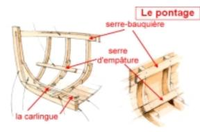
Afin de renforcer la coque sur le bord haut, au milieu et vers la **quille**, on fixera à l'aide de vis :
