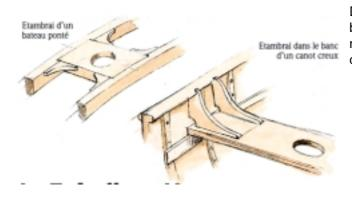
Dernier petit terme de vocabulaire : le trou pratiqué dans un banc ou dans le pont permettant de laisser le **mât**, se nomme l'**étambrai**, ce qui, par extension du langage a donné également ce même nom à ce banc percé.
