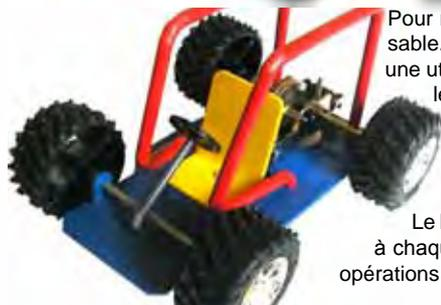
Pour réaliser le **Basik I ou II**, une petite fraiseuse à commande numérique est indispensable. Elle permet en une seule passe de réaliser toutes les pièces nécessaires. Ensuite, une utilisation de la thermoplieuse s'impose pour le châssis, le capot, le siège, les ailes et les arceaux. Les liaisons entre les pièces sont assurées par vis-écrou, coincement, arc-boutement et collage.
