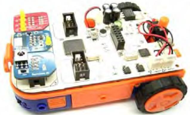
Ce robot est constitué d'une base mobile équipée de 2 moteurs réducteurs avec pneus "gomme" et d'une roue "folle" au centre. La base dispose de capteurs infrarouges latéraux qui permettront au "MA-VIN" de détecter des obstacles proches tandis qu'une autre série de capteurs placés sous la base lui permettra de suivre des lignes au sol. La platine électronique principale du robot dispose d'un port de communication USB ainsi que d'un afficheur LCD alphanumérique 2 x 8 caractères
