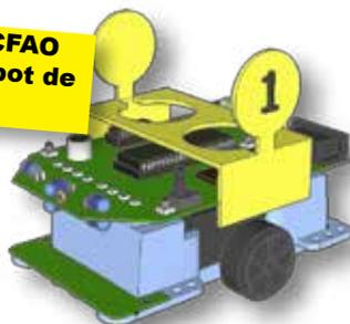
**Moteurs indépendants, détecteurs IR, microphone, haut-parleur, huit leds, photodiodes, etc.**
