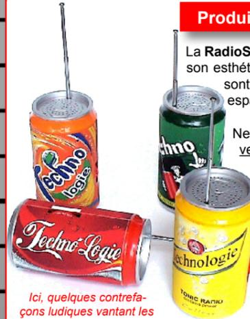
La **RadioSoda** est une radio FM de haute qualité avec antenne et puissant haut-parleur. Nous avons retenu ce produit pour son esthétique, son côté trompe-l'oeil et surtout pour ses qualités techniques et pédagogiques. Les composants utilisés sont des plus classiques et le circuit imprimé propose une sérigraphie propre et précise (Repère et valeur) ainsi qu'un espace très agréable entre les composants.
