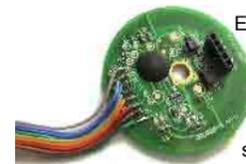
circuit imprimé avec CMS déjà assemblé
