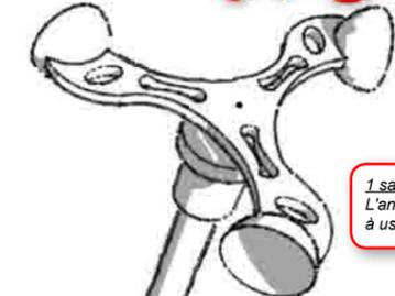
Anémomètre à fabriquer simple et efficace
